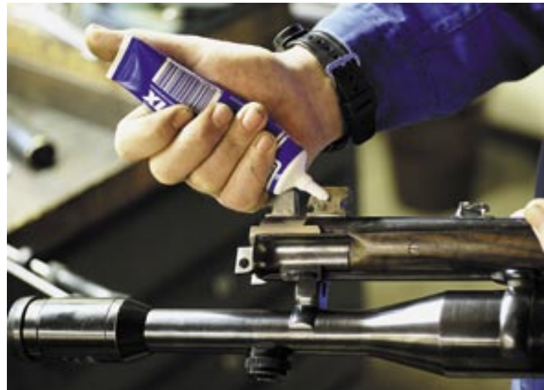
Bewegliche Stellen der Flinte, wie Scharniere, Bolzen und gleitende Flächen, müssen einen dünnen, aber haltbaren Schmierfilm erhalten.
