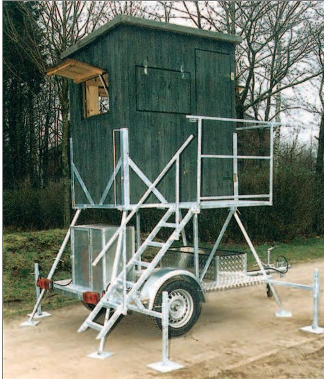
*Vor der Fahrt werden der Aufstieg und das Geländer abgenommen, die Plattform hochgeklappt und die Stützen eingeschoben.*
