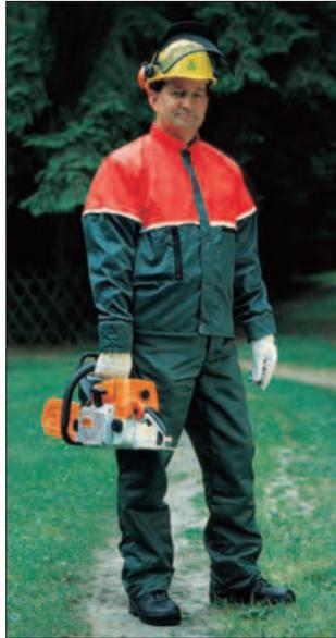
– Wird eine Motorkettensäge eingesetzt, muss persönliche Schutzausrüstung getragen werden. Dazu zählen: Helm mit Gehör- und Gesichtsschutz, Arbeitshandschuhe, Schnittschutzhose und Sicherheitstiefel bzw. -schuhe mit Schnittschutz. Es dürfen nur Erwachsene mit der Kettensäge arbeiten, Jugendliche ab 16 Jahren nur im Rahmen der Ausbildung. Bei der Arbeit ist ein sicherer Stand notwendig (Leitern sind nicht geeignet). Erste-Hilfe-Material muss vorhanden sein. Alleinarbeit ist nicht zulässig.
