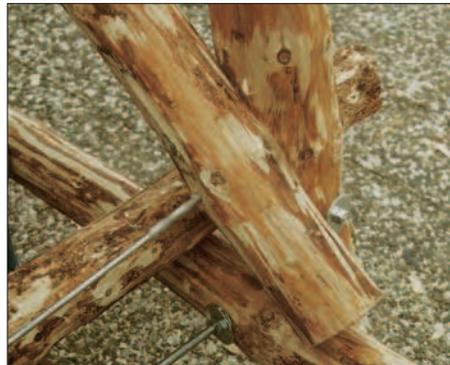
Mit dem Schalungsbohrer ist es möglich, auch mehrere Hölzer in einem Arbeitsgang zu durchbohren.
