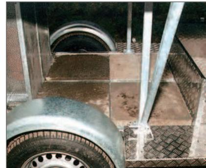
*Mit vier Gehwegplatten als Ballast wird ein möglichst tiefer Schwerpunkt erreicht.*
