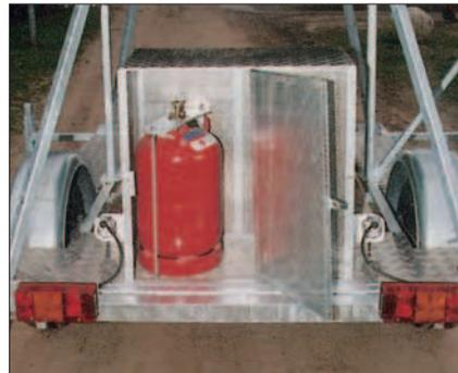
*Die Gasflasche ist in dem abschließbaren, belüfteten Kasten sicher aufbewahrt.*
